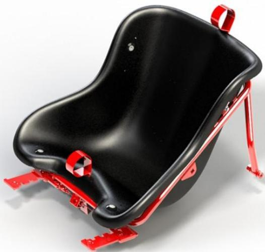
Der Überrollbügel kann bei Unfällen mit Überschlag oder Zusammenstößen die Wucht des rollenden oder fallenden Karts absorbieren und so Verletzungen vermeiden. Der Sicherheitsgurt an der Sicherheitsstange verhindert, dass der Fahrer bei Zusammenstößen oder scharfen Bremsungen gegen Frontteile des Karts geworfen wird, beispielsweise das Lenkrad.
